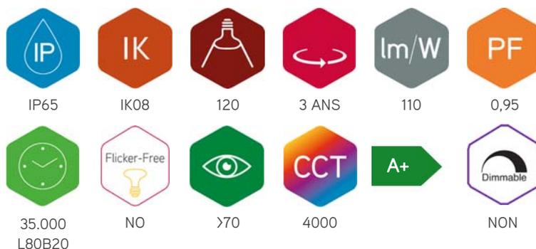
QT Floodlight 24VDC blanc neutral 4000K 50W dans un boîtier noir en aluminium avec protection Interpon pour des environnements corrosifs. Equipé avec une verre de sécurité transparent et un réflecteur de 120°. Livré avec un câble H05RN-F de 1m pré-assemblé. Avec convertisseur DC/DC avec stabilisateur intégré adapté pour une tension d'entrée entre 12-36VDC.
