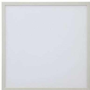
Panneau LED QT 595x595mm avec des bords étroits de seulement 19mm de large. Châssis en aluminium thermolaqué en blanc RAL9016. Equipé de 216 leds SMD4014. Plaque de base laquée avec supports pré-assemblés pour montage pendulaire ou antichute. Livré sans driver. Toujours commander un driver séparément par panneau. Débit lumineux jusqu'à 115 lm/W. Convient pour un driver 30W 750mA ou 36W 900mA. Différents accessoires de montage disponibles. Certification ENEC
