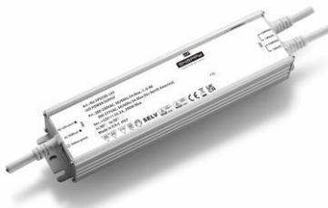
Alimentation ruban LED Constant Voltage, classe 1 en boîtier métallique. Primaire 198-264VAC, secondaire 48VDC 320W. Equipé d'un câble de connexion de 30cm. IP67 pour utilisation dans environments humides, dimmable par contrôle externe. Protégé contre cou
