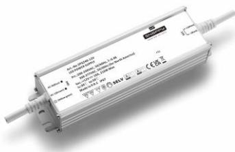
Alimentation ruban LED Constant Voltage, classe 1 en boîtier métallique. Primaire 198-264VAC, secondaire 48VDC 240W. Equipé d'un câble de connexion de 30cm. IP67 pour utilisation dans environments humides, dimmable par contrôle externe. Protégé contre cou
