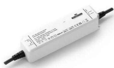
Alimentation ruban LED Constant Voltage, classe 2 en boîtier plastique. Primaire 198-264VAC, secondaire 24VDC 150W. Equipé d'un câble de connexion de 30cm. IP67 pour utilisation dans environnements humides, dimmable par contrôle externe. Protégé contre cour
