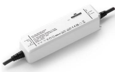
Alimentation ruban LED Constant Voltage, classe 2 en boîtier plastique. Primaire 198-264VAC, secondaire 24VDC 100W. Equipé d'un câble de connexion de 30cm. IP67 pour utilisation dans environnements humides, dimmable par contrôle externe. Protégé contre cour
