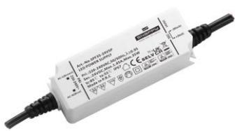
Alimentation ruban LED Constant Voltage, classe 2 en boîtier plastique. Primaire 198-264VAC, secondaire 24VDC 35W. Equipé d'un câble de connexion de 30cm. IP67 pour utilisation dans environnements humides, dimmable par contrôle externe. Protégé contre court
