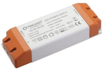
Alimentation ruban LED Constant Voltage, classe 2 en boîtier plastique. Primaire 198-264VAC, secondaire 24VDC 150W. Equipé de connexions câbles vissables. IP20, dimmable par contrôle externe. Protégé contre courts-circuits, surcharges et surtension.
