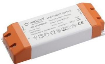
Alimentation ruban LED Constant Voltage, classe 2 en boîtier plastique. Primaire 198-264VAC, secondaire 24VDC 100W. Equipé de connexions câbles vissables. IP20, dimmable par contrôle externe. Protégé contre courts-circuits, surcharges et surtension.
