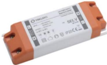
Alimentation ruban LED Constant Voltage, classe 2 en boîtier plastique. Primaire 198-264VAC, secondaire 24VDC 20W. Equipé de connexions câbles vissables. IP20, dimmable par contrôle externe. Protégé contre courts-circuits, surcharges et surtension.
