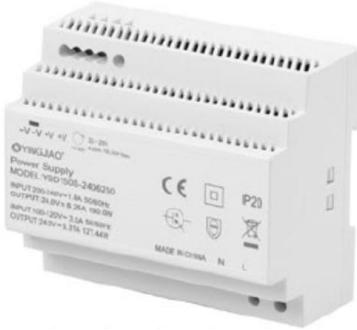
Alimentation ruban LED Constant Voltage, classe 2 en boîtier plastique. Primaire 198-264VAC, secondaire 24VDC 150W. Boîtier Din-Rail 6 modules (largeur module) IP20, dimmable par contrôle externe. Protégé contre courts-circuits, surcharges et surtension.
