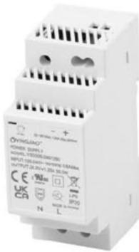
Alimentation ruban LED Constant Voltage, classe 2 en boîtier plastique. Primaire 198-264VAC, secondaire 24VDC 30W. Boîtier Din-Rail 2 modulless (largeur module) IP20, dimmable par contrôle externe. Protégé contre courts-circuits, surcharges et surtension.
