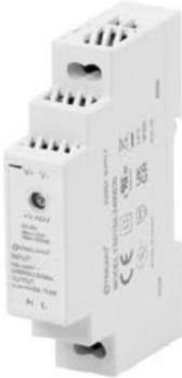
Alimentation ruban LED Constant Voltage, classe 2 en boîtier plastique. Primaire 198-264VAC, secondaire 24VDC 15W. Boîtier Din-Rail 1 module (largeur module) IP20, dimmable par contrôle externe. Protégé contre courts-circuits, surcharges et surtension.
