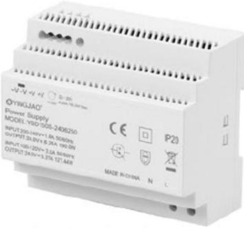
Alimentation ruban LED Constant Voltage, classe 2 en boîtier plastique. Primaire 198-264VAC, secondaire 24VDC 150W. Boîtier Din-Rail 6 modules (largeur module) IP20, dimmable par contrôle externe. Protégé contre courts-circuits, surcharges et surtension.
