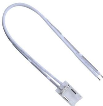
Connecteur sans outil avec câble de connexion 15cm pour ruban led IP20 monochrome de 8mm largeur. Max. 24V 3,5A, section de câble 0,5 mm<sup>2</sup>. Résistant à la chaleur jusqu'à 105 °C.
