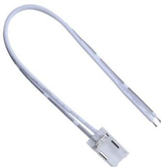
Connecteur sans outil avec câble de connexion 15cm pour ruban led IP20 monochrome de 10mm largeur. Max. 24V 3,5A, section de câble 0,5 mm<sup>2</sup>. Résistant à la chaleur jusqu'à 105 °C.
