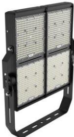
Luminaire extrêmement efficace avec une durée de vie très élevée, équipé avec drivers de qualité et de puces LED EMC5050, rendement jusqu'à 180lm/W selon le type de lentille. Protection intégrée contre les surtensions de 20kV.
