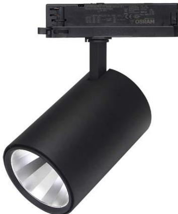
Tracklight réglable pour rail triphasé universel Eutrack. Boîtier noir RAL9004 équipé avec puce LED Citizen à haut rendu des couleurs CRI90 et réflecteur Alanod de 30° avec un rendement de 97%. Adaptateur de rail Powergear avec driver Osram flickr free intégré, non dimmable. Durée de vie 50.000 heures L80B20, garantie 5 ans.
