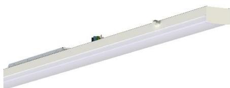
Module LED Dreamline 63W avec diffuseur PMMA opalin 120° pour système en lignes, longueur 1437mm, efficacité jusqu'à 160lm/W selon version. Equipé d'un driver Osram réglable DALI, puissance réglable 57W/63W avec dip switch. Avec unité de secours interne 3 heures. Puissance lumineuse en secours 10W.
