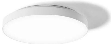
Luminaire IP54 appaissant élégant 20W blanc neutral 4000K avec base blanc RAL9003 et une couverture opalin en polycarbonate résistant aux chocs IK10. Equipé avec la dernière génération de puces led SMD2835 et un driver 'flicker free' intégré. Grâce à la base de montage séparée et aux bornes de connexion sans vis, le luminaire peut être installé très rapidement. Avec unité de secours 3h intégré.
