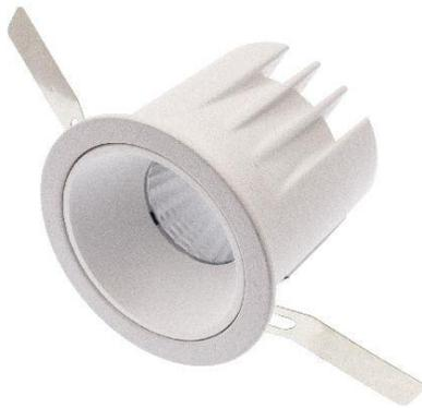
Spot encastré DEEP IP20 avec revêtement en poudre blanc. Le boîtier en aluminium moulé sous pression a un réflecteur blanc avec un faisceau de 38°. Découpe seulement 60 mm. Source LED Bridgelux plus profonde avec un rendu des couleurs élevé CRI90 et faible éblouissement UGR<19. Le spot encastré est équipé de ressorts à lames pour un montage facile dans le béton. Un câblage rapides est possibles grâce à la boîte de connexion sans outil incluse.
