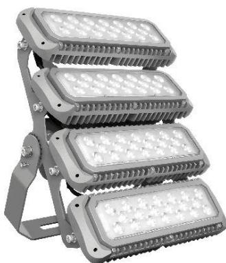
Projecteur industriel Brightmaster 2 avec lentille 110°. Boîtier en aluminium gris IP65 pour un refroidissement plus efficace. Revêtement Interpon pour environnements corrosifs. Modules LED directionnels avec Lumileds 3030/5050 et driver Meanwell HLG. Équipé d'une boîte de jonction et d'un câble de 1,3 m H05RN-F.
