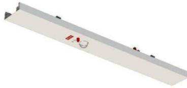
Module Dreamline vide avec capteur microwave intégré DALI et capteur de lumière du jour. Détection jusqu'à 6 mètres. Tension 120-277Vac 50/60Hz. Charge maximale 15 modules ~ 30mA par capteur. Sensibilité réglable 10/50/75 ou 100%. Temps d'activation 30s/1m/5m/10m/20m ou 30m. Capteur de lumière du jour 2/10/50 ou éteint. Stand-by fonction corridor 0/10s/1m/5m/10m/30m/14h ou éteint. Stand-by niveau dimming 5/10/20 of 50%.
