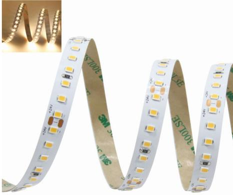
Ruban LED full spectrum 140 SMD2835 LED par mètre. CRI > 97, le spectre entièrement visible est affiché uniformément et naturellement. Voltage de connexion 24VDC, réglable avec variateur PWM. Convient aux applications intérieures IP20, rouleau de 5m, puissance 14,4W par mètre, peut être raccourcie tous les 5 cm. Câble de connexion de 30 cm des deux côtés. Connectez maximum 8m en série avec l'alimentation d'un côté. Application: représentation naturelle des couleurs.
