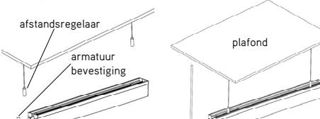
Monteer de plafondhouders van de pendelset op een afstand naar keuze. De pendelset kan over de volledige lengte van het armatuur bevestigd worden. Schuif de staalkabel door de schroef van de plafondhouder en bevestig deze.
