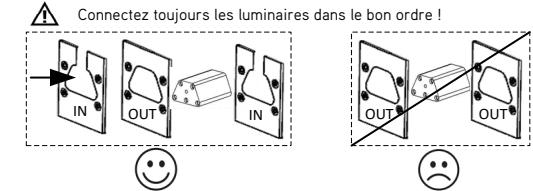
L'installation et la maintenance doivent toujours être effectuées par du personnel qualifié. La source lumineuse de ce luminaire n'est pas remplacable, le luminaire doit être remplacé à la fin de sa vie.
