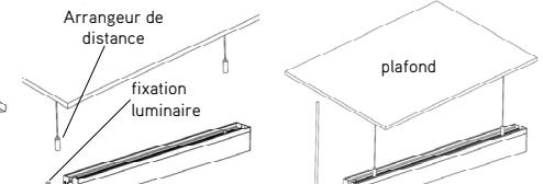
Placez l'arrangeur de distance sur le câble en acier et choisissez la longueur de pendule souhaitée. Retirez le capuchon du embout et glissez la fixation luminaire dans le support. Poussez le connecteur dans le luminaire.
