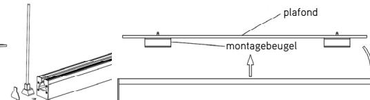
Monteer de montagebeugels op een afstand naar keuze. De beugels kunnen over de volledige lengte van het armatuur bevestigd worden.
